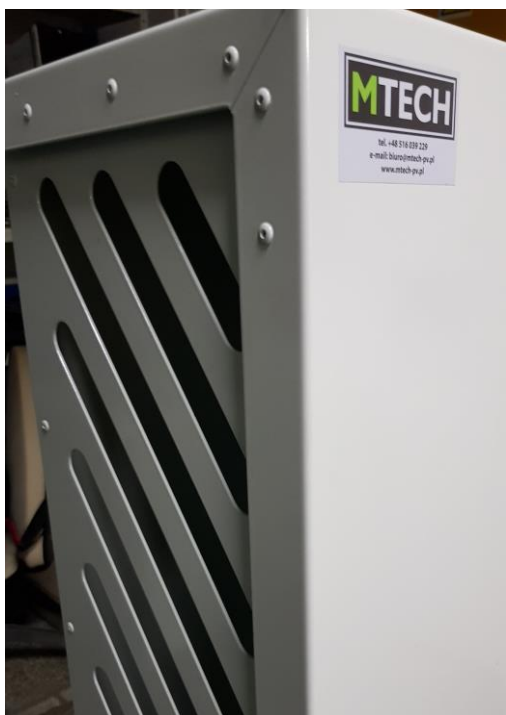
Rys. 3.6. Metalowa szafa z zamkiem – widok szczelin umożliwiających przepływ powietrza.
